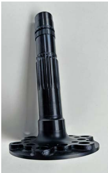
Arbre d'hélice ZAE recouvert d'un traitement de surface anti-corrosion type.
