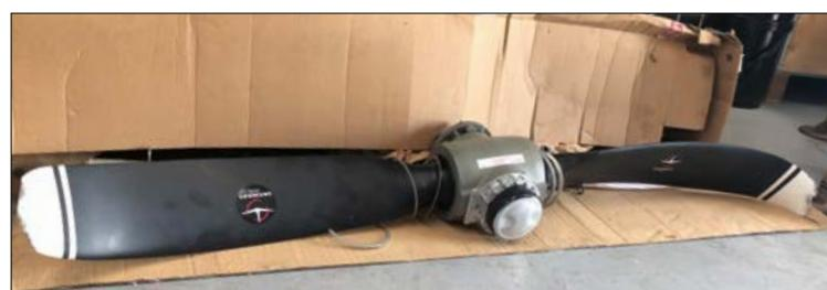
En cas de prop strike sur un avion, la machine doit passer par un atelier agréé pour être remise en vol. Dans le cas d'un ULM, le simple remplacement de l'hélice peut suffire à repartir en vol, mais sachez qu'il est impératif de respecter auparavant les procédures établies par le motoriste. Tout cela pouvant être effectué directement par le pilote propriétaire.
