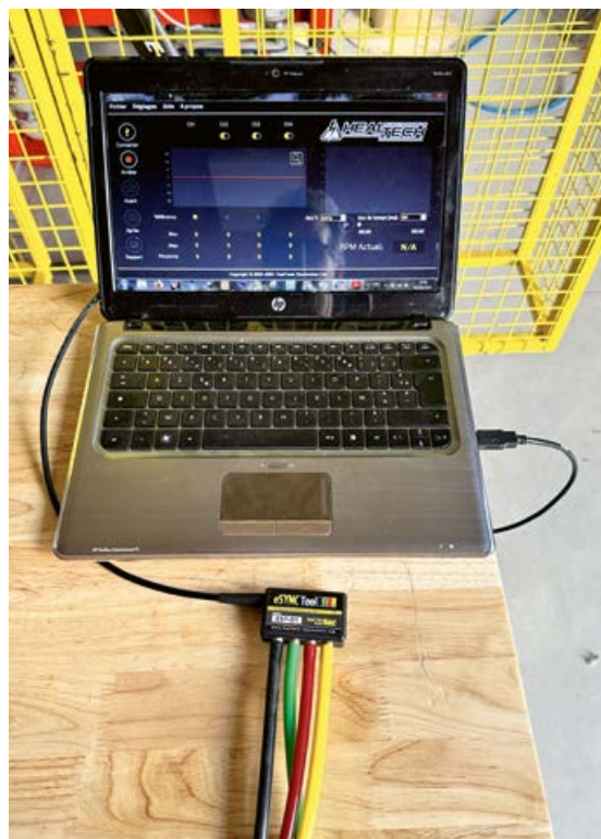
Le HealTec permet un enregistrement des réglages, mais nécessite un PC avec une connexion à Internet.
