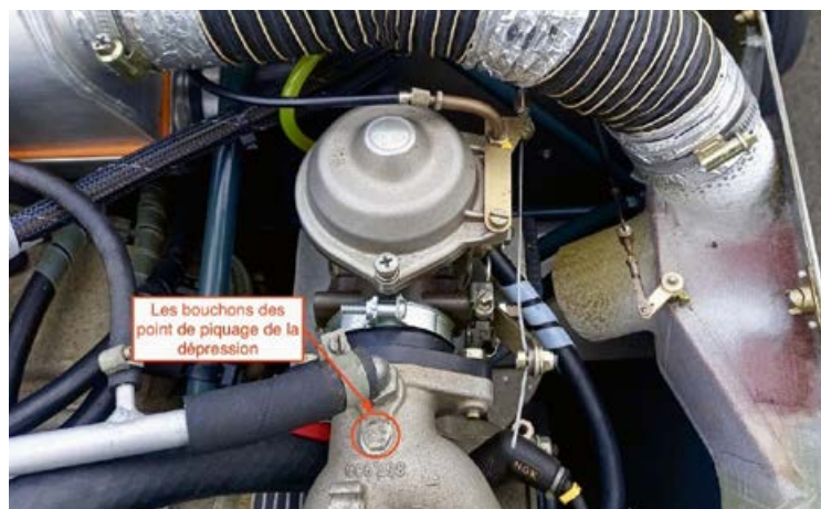
Les points de raccordement des outils de réglage pneumatique.
