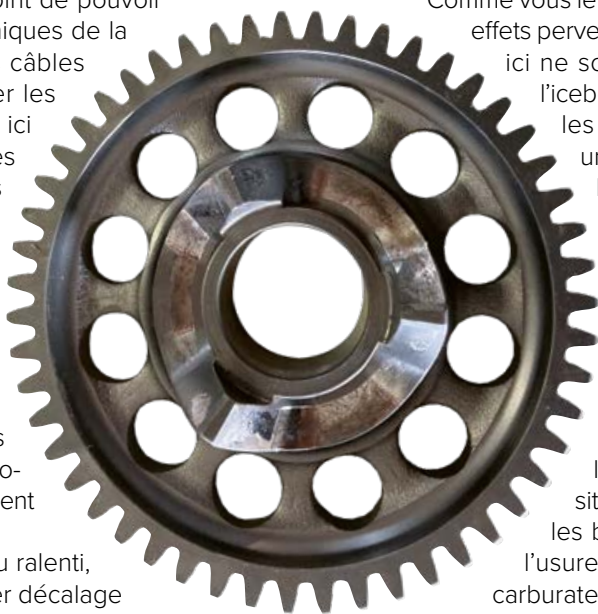
La dent de chien et les cannelures de la boîte de vitesses subissent directement les méfaits d'une synchronisation déficiente...
